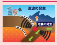
ひずみがその限界に達したとき、ユーラシアプレートが跳ね上がり、地震が発生します。その際、津波が発生します。
